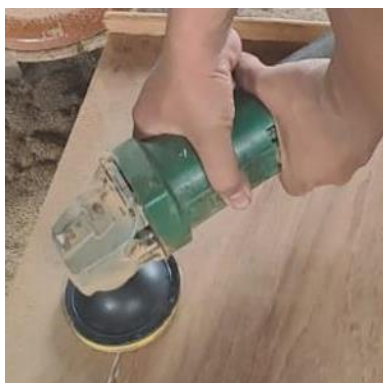
Gambar 18. Pengamplasan tahap akhir Kayu
