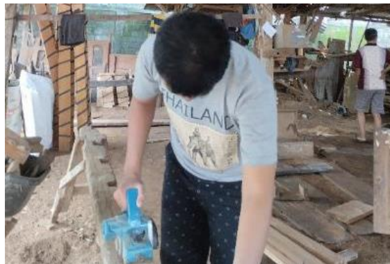
Gambar 12. Meratakan permukaan kayu
